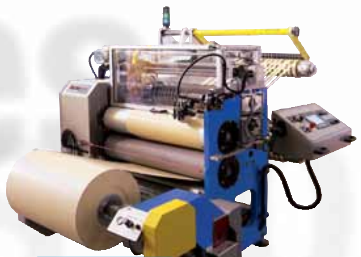
TG100 automatica 850 - 1000 - 1300 Taglierina ribobinatrice ad uno o due avvolgitori per bobine, bordi spessore max 2 mm, gestione ciclo di lavoro e campo di taglio automatico
