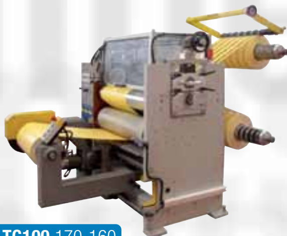
TG100 170-160 1000 - 1300 Taglierina ribobinatrice ad uno o due avvolgitori per bordi forte spessore
