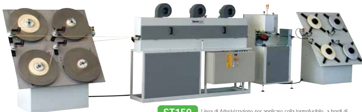
ST150 Linea di Adesivizzazione per applicare colla termofusibile a bordi di laminato plastico, ABS, PVC, melaminico, legno Glueing line for applying hot-melttable adhesive to plastic laminate, ABS, PVC, melamine, wood edges Verleimstrasse zum Auftragen von Heißschmelzkleber auf Kanten aus Plastiklaminat, ABS, PVC, Melamin oder Holz Linea de encoladura para aplicar la cola termofusible sobre bordes de laminado plástico, ABS, PVC, melaminico, madera
